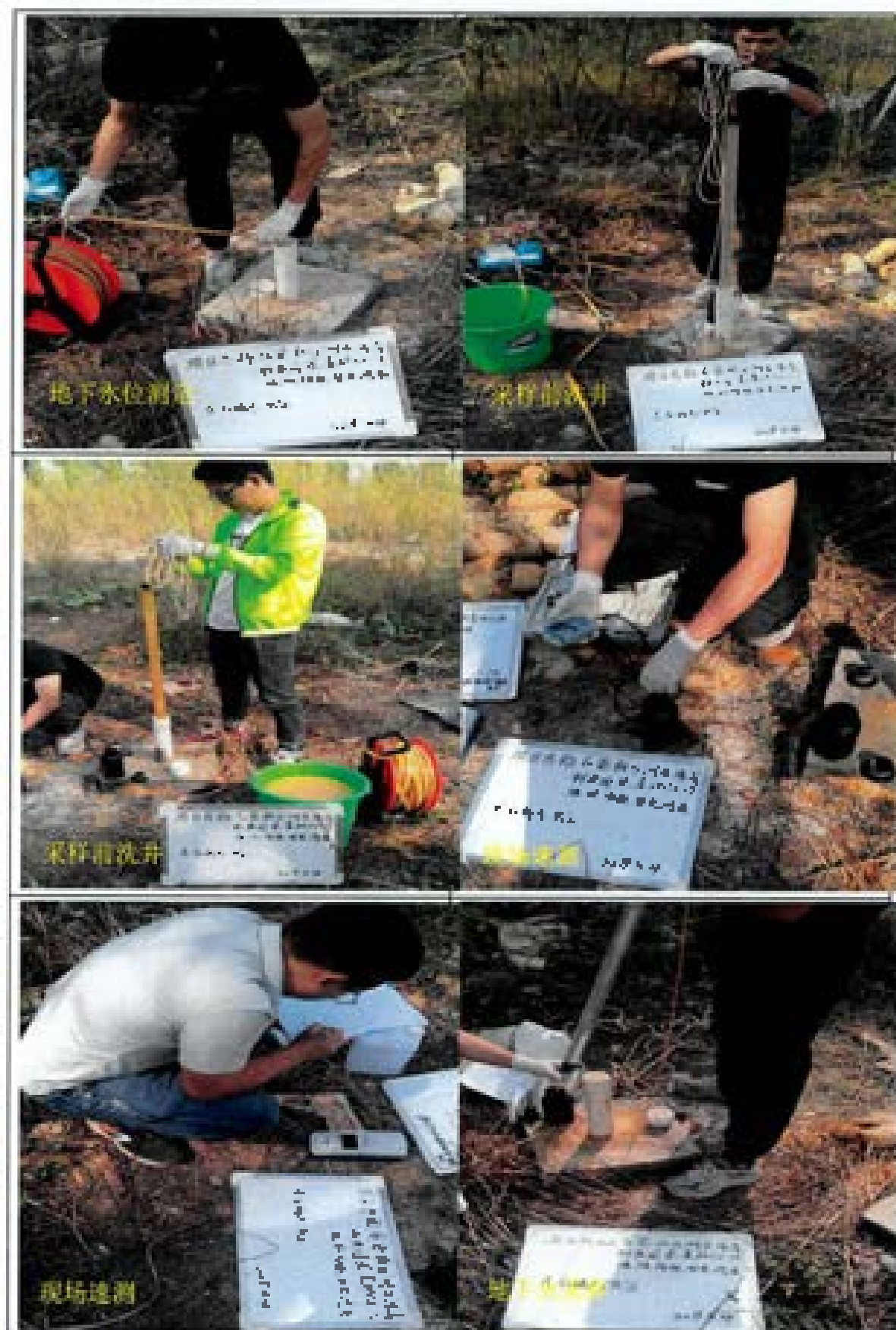
图 4.2-8 地下水采样前洗井以及采样现场照片
